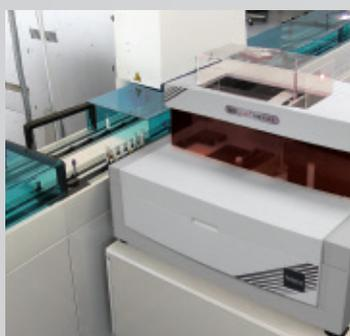
Le V8 Nexus connecté à une Chaîne peut réaliser plus de 2300 tests SP par jour. Le Platinum 5 renverra automatiquement les résultats avec les pics marqués et identifiés, pour les chaînes suivantes : Inpeco FlexLab, Abbott Accelerator, Siemens, Aptio.
